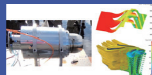
図2: SUSANO企業と学生で作っている小型ジェットエンジンです。設計にはシミュレーションも使っています。
