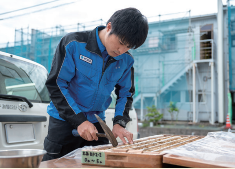
ボーリングコアを観察する吉原さん。採取したものをハンマーでたたいて状況を確認します。
