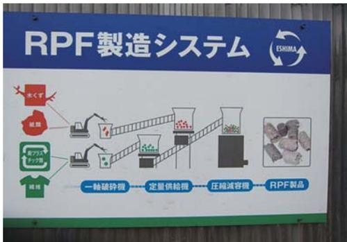
三光株式会社(工場各所)並びに王子製紙株式会社島大から受取った「洗浄済みプラスチック瓶等」をRPF固形燃料に加工し、その後「王子製紙」で燃料として使う。
