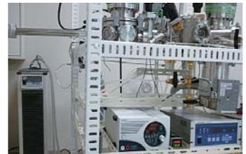
真空スタック堆積装置に使用された冷却水循環装置
